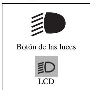
Para encender los faros delanteros y traseros, pulse el botón de las luces: el botón se pondrá verde. Para apagar las luces, vuelva a pulsarlo.
