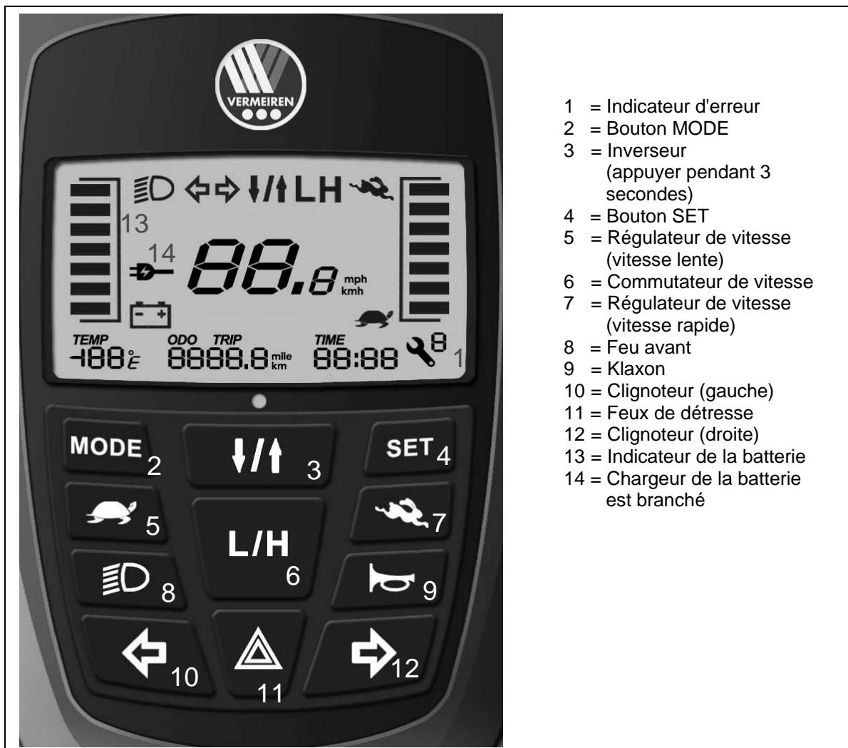
Placez le commutateur ON/OFF sur ON, attendez 3 secondes avant d'enfoncer la pédale des gaz, autrement vous voyez apparaître une alarme « ralentissement protection ». L'écran LCD s'allume maintenant.
