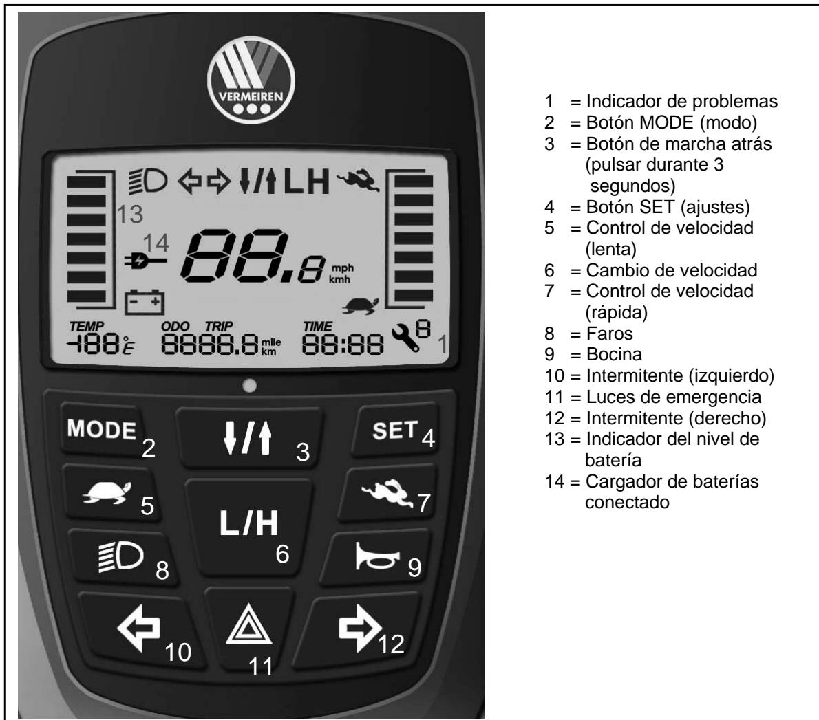
Ponga el interruptor ON/OFF en la posición ON de encendido y espere al menos 3 segundos antes de pulsar la palanca de velocidad; de lo contrario, saltará la alarma de protección de retardo. La pantalla LCD se encenderá.
