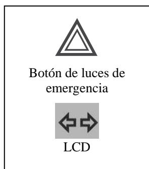
Para encender las luces de emergencia, pulse el botón del triángulo: al mismo tiempo, el botón parpadeará en rojo y los botones de los intermitentes se pondrán en verde.
